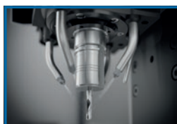
DATRON Minimalmengen- Kühlschmierung mit 4-Düsen Sprüheinheit (verstellbar)
